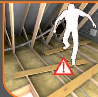
Créer une surface accessible et sécurisée, donnant accès au réseau technique sous toiture (VMC, antenne...)
